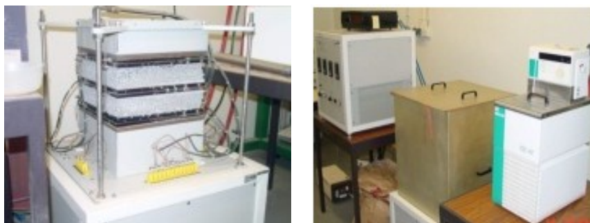
Fig. 2.2. – Equipamento Holometrix GHP-300 do LFC da FEUP, utilizado para medir a condutibilidade térmica (LFC, 2007)
