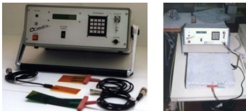
Fig. 2.3. – Equipamento CT-Mètre do LFC da FEUP, utilizado para medir a condutibilidade térmica (LFC, 2007)
