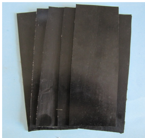
Figura 21 - Placa de adesivo após cura.
