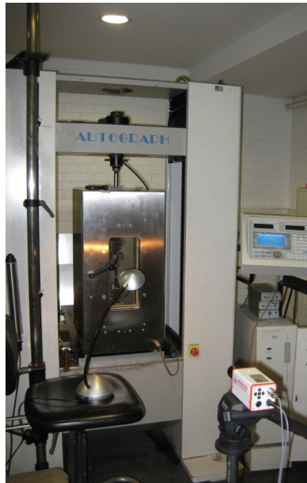
Figura 23 - Máquina para ensaios de tracção de provetes maciços.
