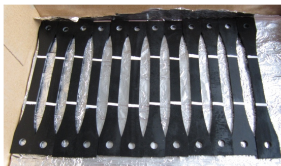
Figura 22 - Provetes para o ensaio de tracção de provetes maciços.
