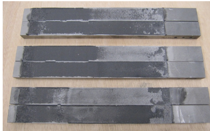
Figura 72 - superfície de rotura dos provetes ENF.
