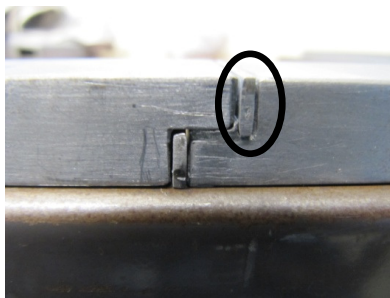
Figura 27 - Posicionamento dos calços nos provetes para o ensaio TAST.
