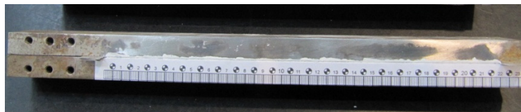
Figura 45 - Conclusão do fabrico do provete ENF.
