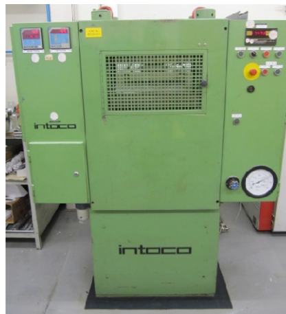
Figura 18 - Prensa hidráulica de pratos quentes.
