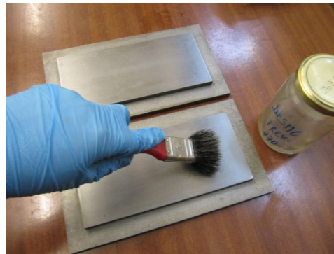
Figura 17 - Aplicação do desmoldante nas placas do molde.
