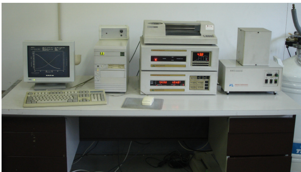
Figura 14 - Máquina para efectuar o ensaio de DMA.
