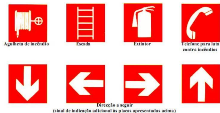
Fig. 5.33 – Sinalização de incêndio, [11]
