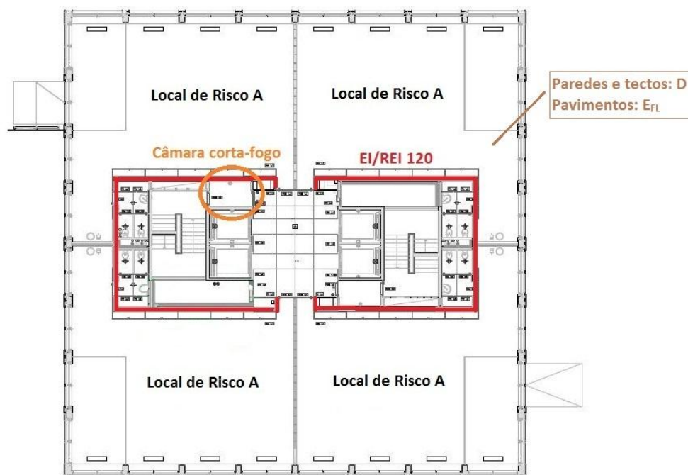
Fig. 5.13 – Características de isolamento e reacção ao fogo dos pisos da Torre
