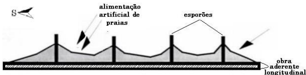
Fig.4 – Exemplo de solução mista, com construção de obra aderente (Veloso Gomes, 1991).
