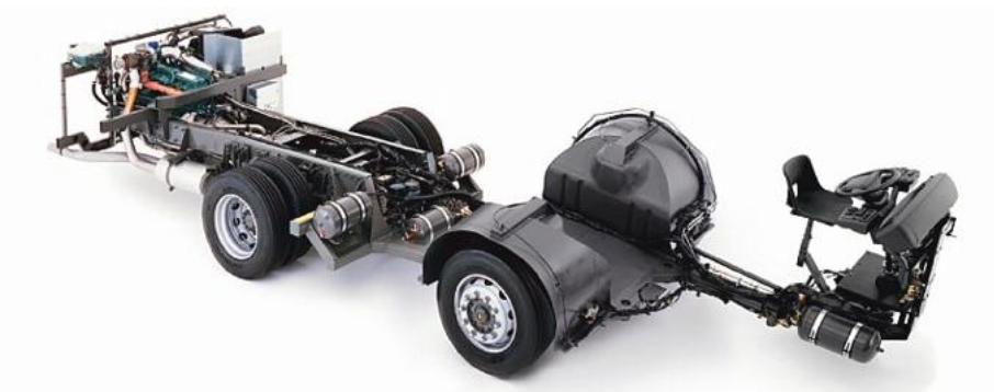
Figura 14 – Chassi de um autocarro urbano com respectiva cadeia cinemática (Fonte: VOLVO, 2011)
