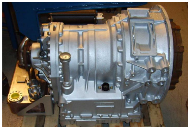
Figura 43 – Caixa de velocidades automática (Fonte: Truck-Market, 2009)
