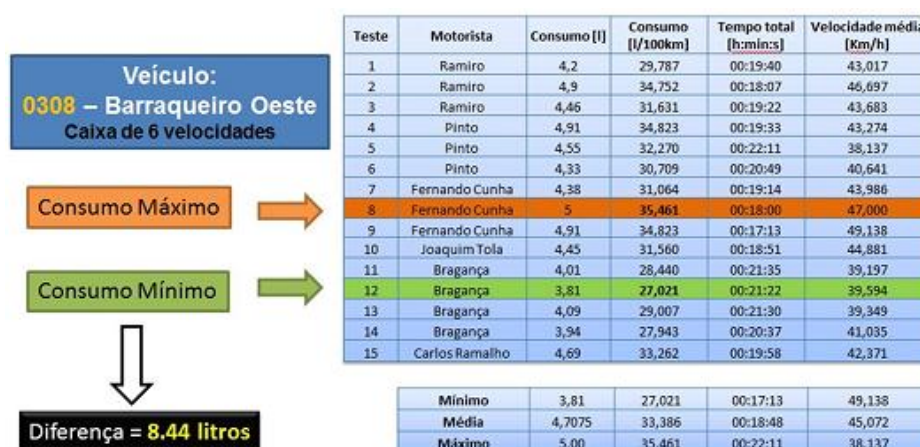
Figura 13 – Testes efectuados para estudar influência dos comportamentos dos motoristas no consumo de combustível (Fonte: Oliveira, L., 2010)
