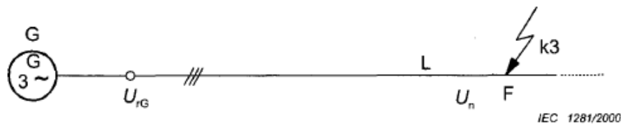
Figura 3.19 - Curto-circuito alimentado directamente por um gerador[15].
