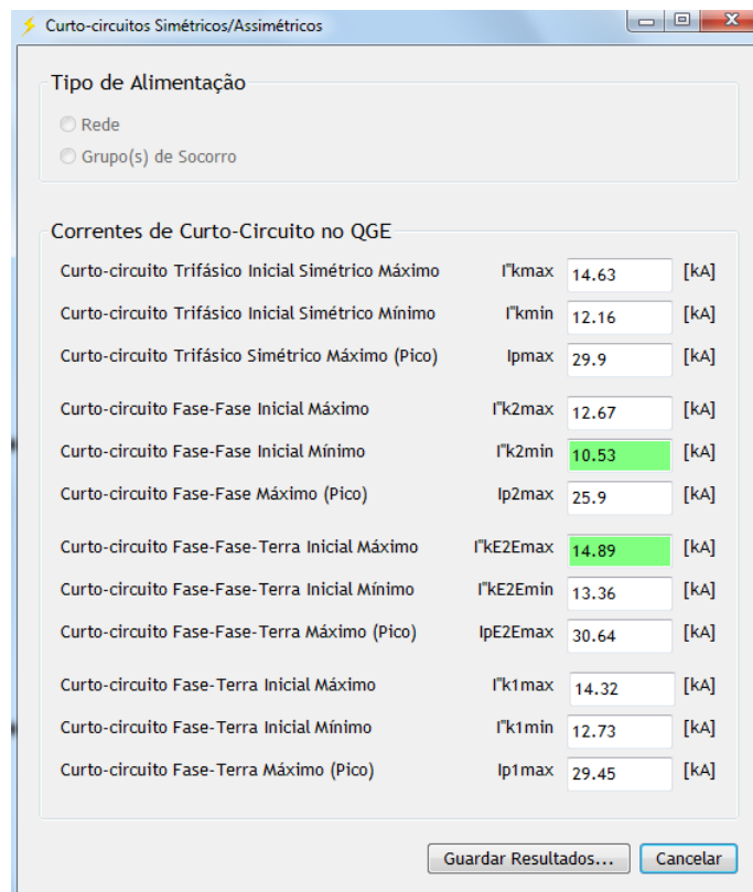
Figura 5.15 - Curto-Circuitos Simétricos/Assimétricos no QGE: Exemplo Teste 3
