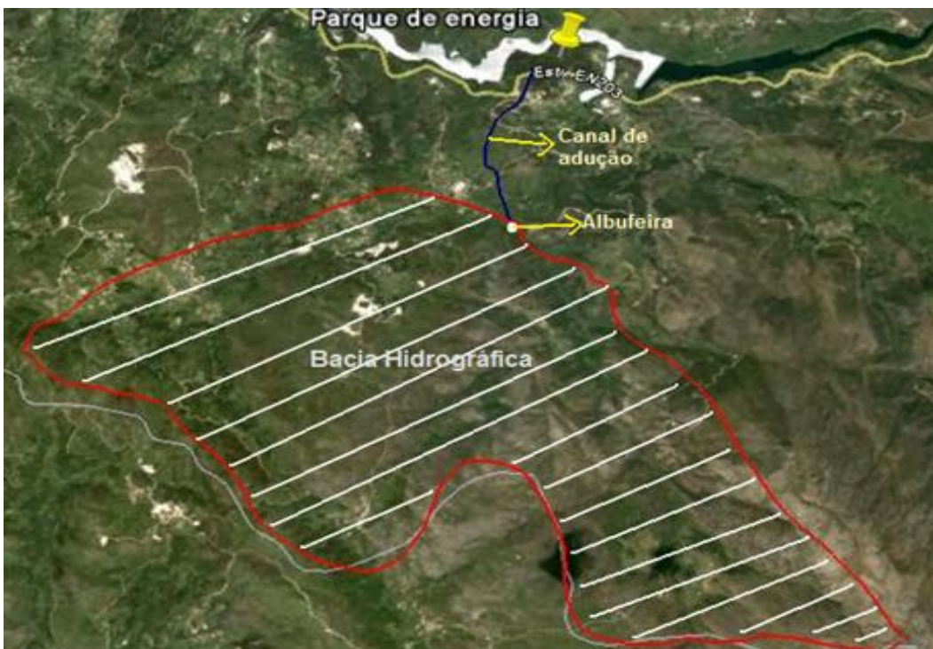
Figura 43: Demonstração da bacia hidrográfica para a mini-hídrica e da conduta forçada.
