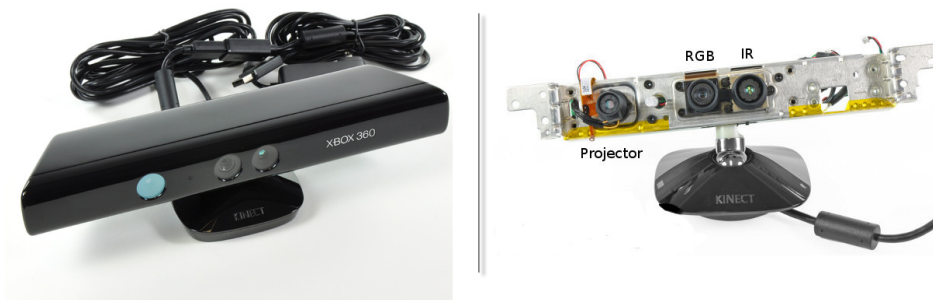
Figura 3.11: Exterior ( esquerda ) e interior ( direita ) do controlador Kinect (36)
