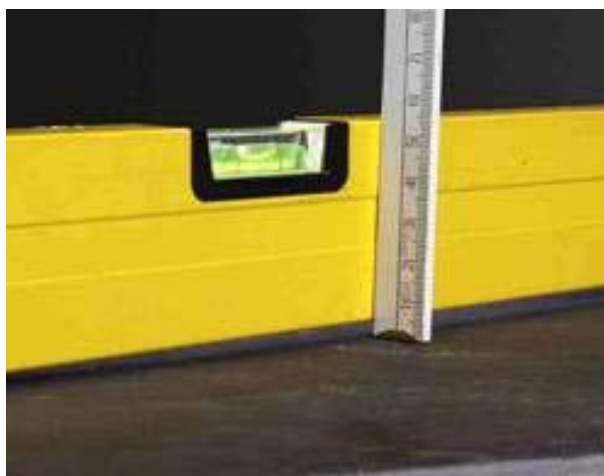
Fig. 30 - Material para a avaliação da planimetria (régua de nível) (Garcia, J., 2006).
