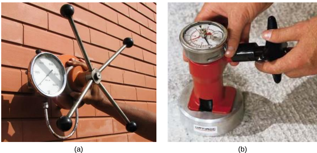
Fig. 38 – (a) (b) Equipamentos para o ensaio pull-off (Garcia, J., 2006).
