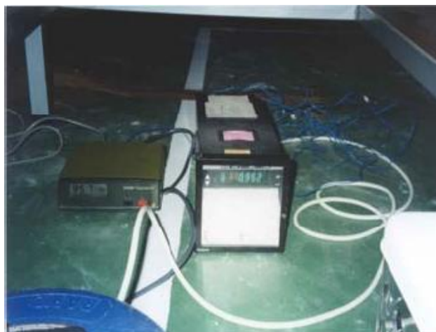
Fig. 40 – Equipamento utilizado para registo da temperatura e humidade em profundidade (Garcia, J., 2006).
