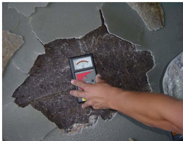
Fig. 31- Medição da humidade superficial (Garcia, J., 2006).
