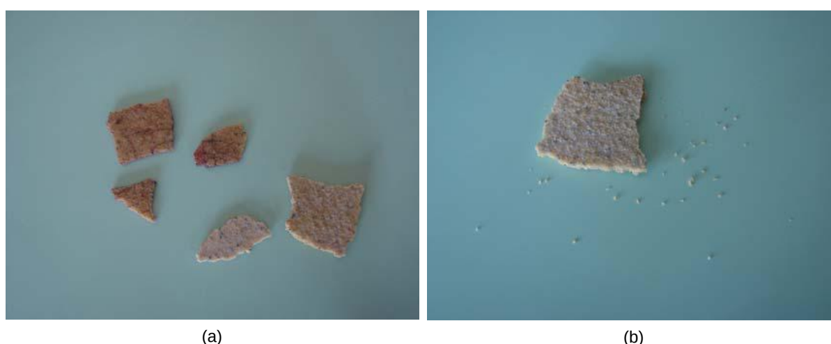
Fig. 74 – Amostras de revestimento de pavimento à base de resinas de metacrilato em que é visível a fissuração, desagregação e branqueamento/alteração de cor
