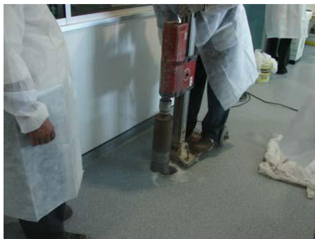
Fig. 36 – Realização de ensaio com caroteadora.
