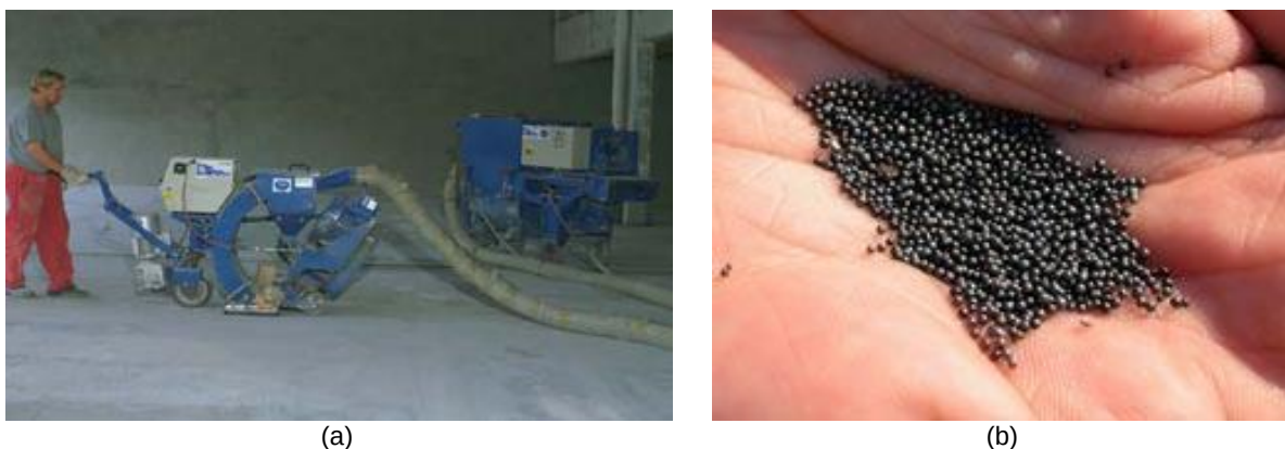
Fig. 11- (a) Equipamento para granalhagem; (b) granalha de aço esférico (Moura, M.V., 2003a).
