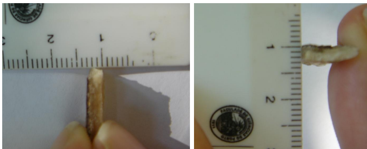
Fig. 67 – Medição da espessura de amostras do revestimento à base de resinas de metacrilato.
