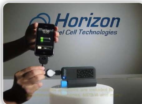
Figura 43. Carregador telemóvel portátil, com a energia gerada a partir das células de combustível de hidrogénio [25]
