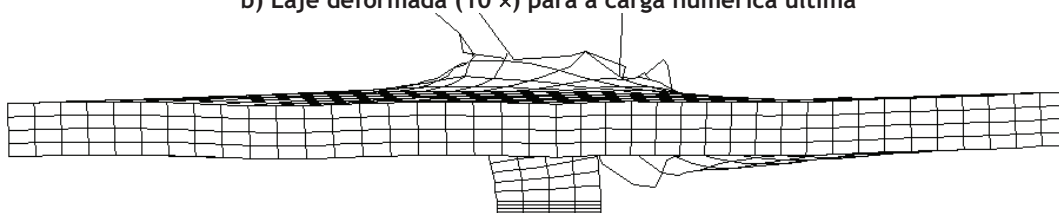
b) Laje deformada (10 ×) para a carga numérica última
