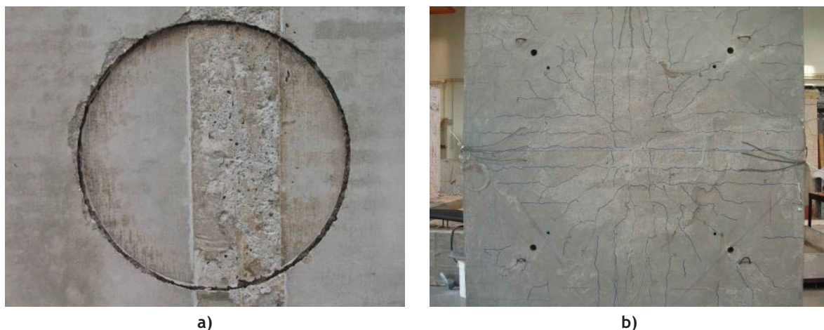
Figura VI-2 - Vista da laje P após o ensaio: a) face inferior; b) face superior.
