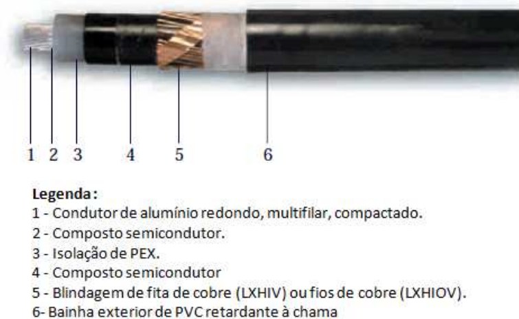
Figura 3.15 - Constituição dos cabos de linhas subterrâneas - LXHIOV [45]
