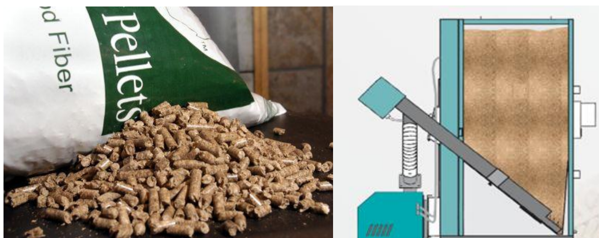
Figura 60: Amostra exemplificativa de peletes (esquerda) e exemplo esquemático de um queimador de peletes (direita) 6 .
