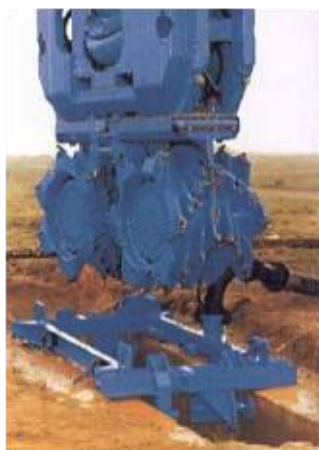
Fig. 3.38 – Pá escavadora utilizada na escavação de valas (Sousa et al. , 2006).
