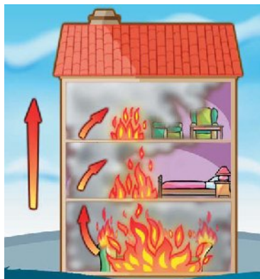
Figura 2.9. – Transmissão de calor por convecção, [5].
