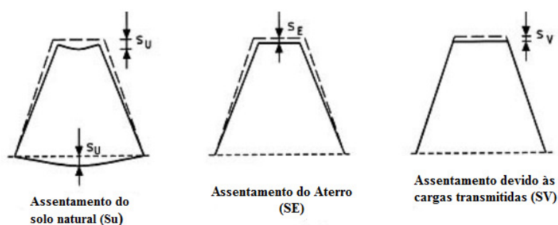
Fig.4. 3 - Assentamentos ao longo da via (adaptado de ERRI, 1999)
