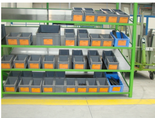
Figura 26 – Supermercado de Abastecimento 4017
