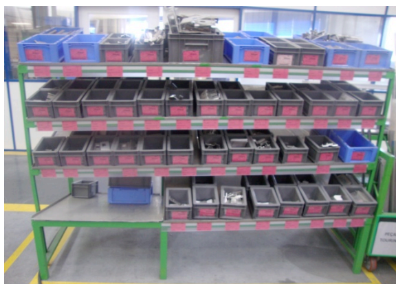
Figura 27 – Supermercado de Abastecimento 4016
