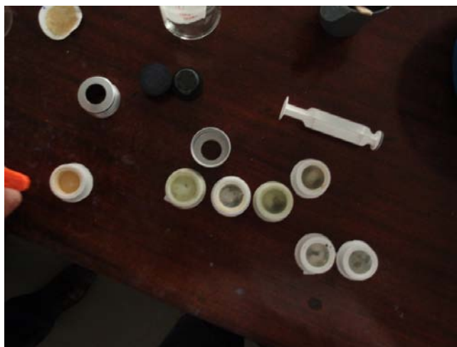
Fig. 5.2 - Moldes e epoxy para montagem das amostras para polimento
