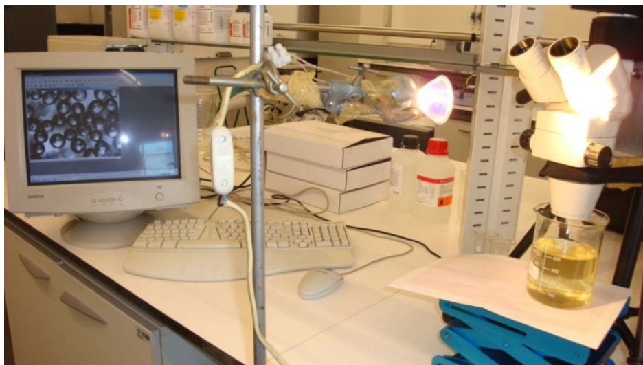
Fig. 4.11 - Dispositivo para a determinação da evolução granulométrica das partículas de ferro
