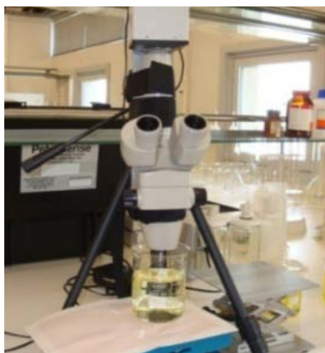
Fig. 4.9 - Dispositivo de captação das imagens das esferas de ferro em solução de Cr(VI)
