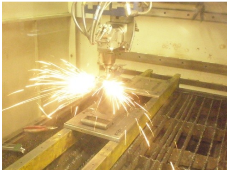
Figura 66 – Execução do Corte do Protótipo no Laser 3D
