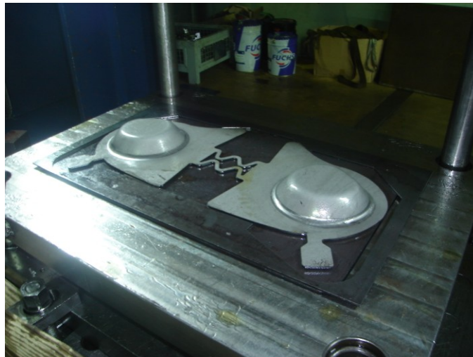
Figura 80 – Obtenção de pré-forma de embutidura “Spring Seat”
