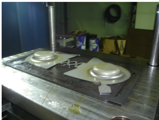
Figura 81 – Última etapa de embutidura “Spring Seat”
