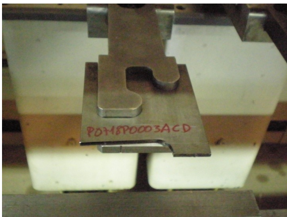
Figura 70 – Máscara de guiamento montada na quinadora
