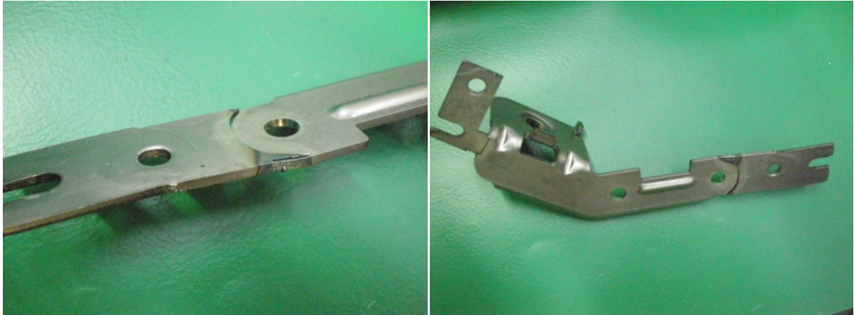
Figura 76 – Pormenor de micro-união após o corte
