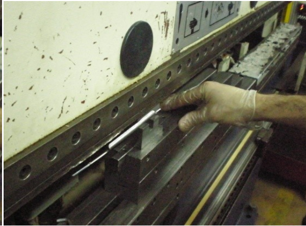
Figura 73 – Quinagem do 'Filler Head Bracket'
