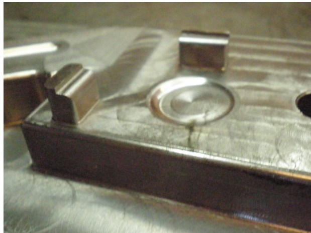
Figura 68 – Pormenor da montagem dos postigos para dobragem das abas
