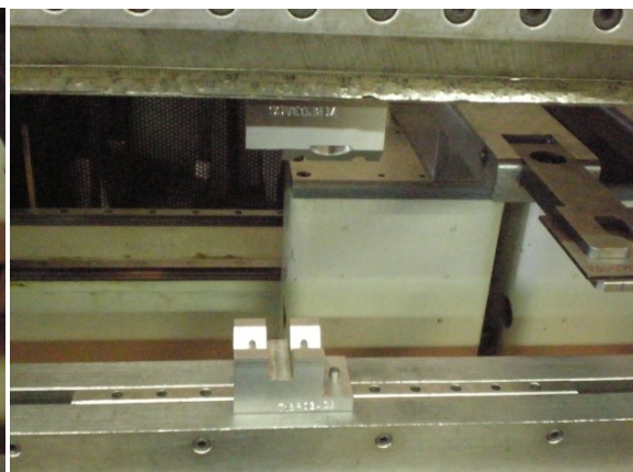
Figura 71 – Ferramenta montada na Quinadora
