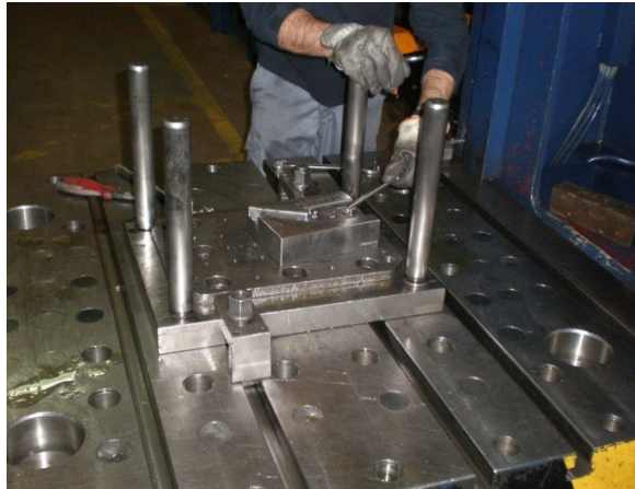
Figura 63 – Extracção do estampado do ‘Filler Head Bracket’
