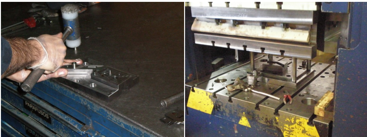
Figura 62 – Preparação da Ferramenta e montagem na prensa
