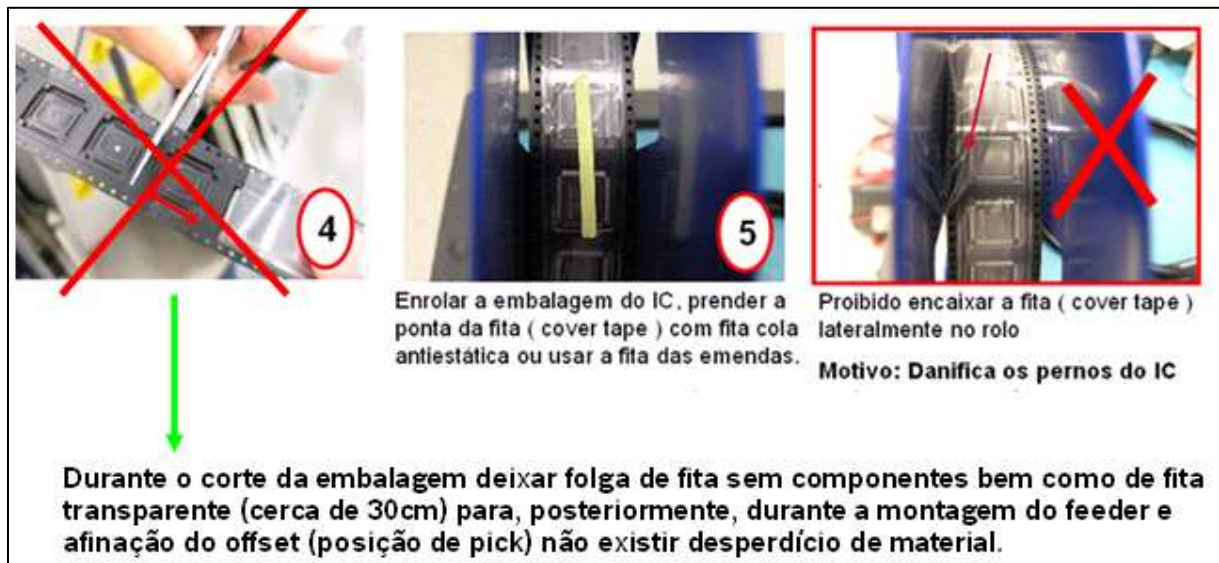
Figura 30 – Exemplo 2 do procedimento de montagem/desmontagem dos feeders
