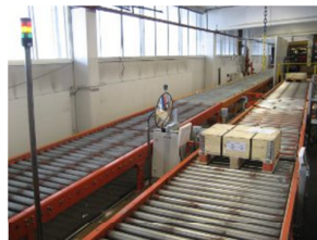
Figura 21 -Leitores de RFID inseridos na linha [20]
