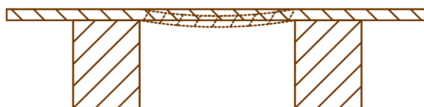
Fig. 2.14 - Pavimento de soalho tradicional
