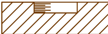
Fig. 3.12 - Cavidade com paredes verticais
