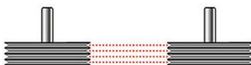
Figura 10 - Polias correctamente alinhadas. As ranhuras encontram-se alinhadas entre si. (SKF, 2011)
