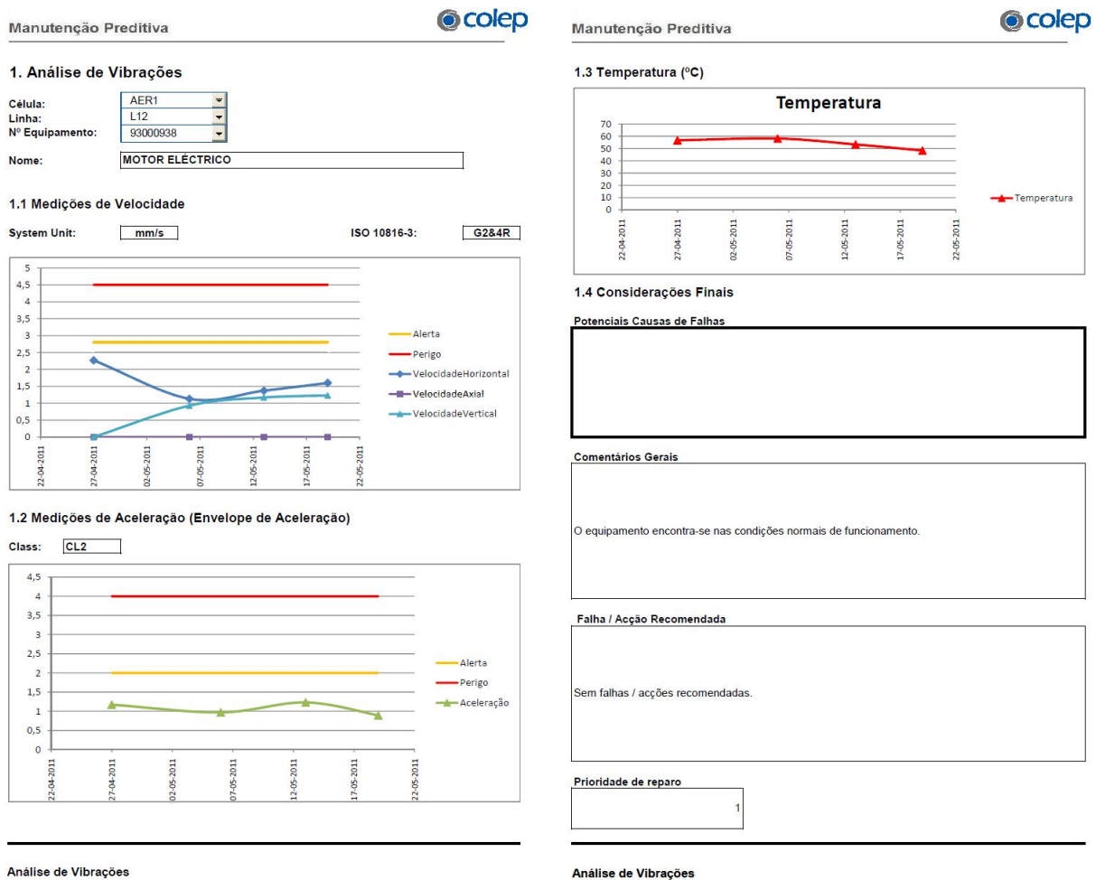
Figura 17 - Exemplo da folha de monitorização de dados para as medições de vibração.
