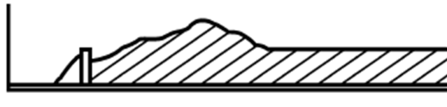
Figura 34 - Sobrecarga do Betão Fresco
