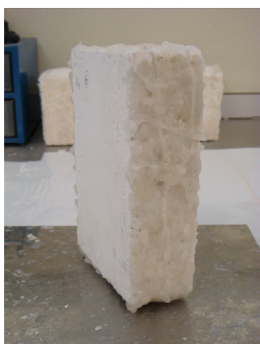
Figura 3.5 – Provete com face impermeabilizada
