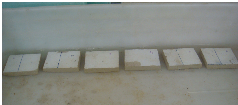
Figura 3.15 – Provetes de gesso projectado mergulhados em água
