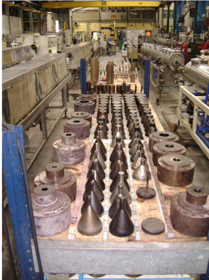
Figura 10 – Banca de arrumo das ferramentas que está entre as linhas B3 e K1 depois da melhoria dos 5S
