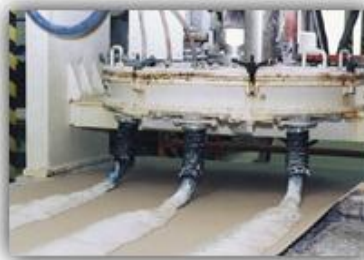
Fig. 2.4 - Pasta de gesso sobre lâmina de papel
