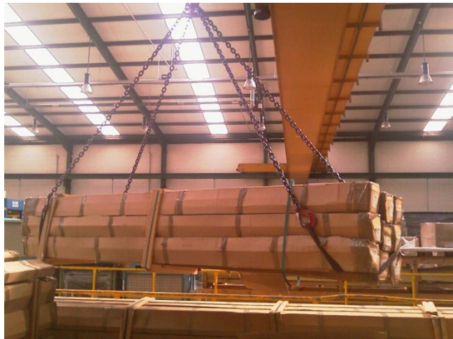
Figura 21 - Movimentação de Perfis de Alumínio com a Ponte Rolante.
