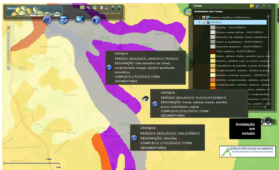
Figura 12. Caracterização litológica do local da instalação e sua envolvente [12]
