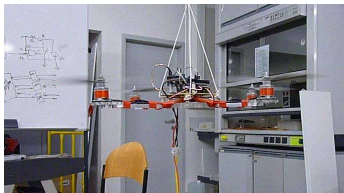
Figura 8.3 - Teste realizado ao veículo com um grau de liberdade para o ângulo \psi para diferentes referências
