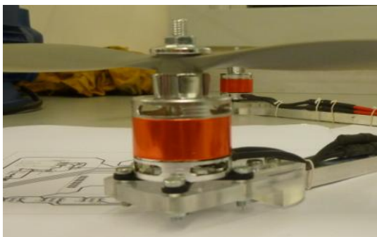
Figura 4.1 - Vista lateral da base do motor, com o motor e propulsor montado
