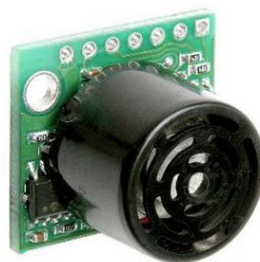
Figura 5.22 - Sensor de baixas altitudes, LV-MaxSonar-EZ1
