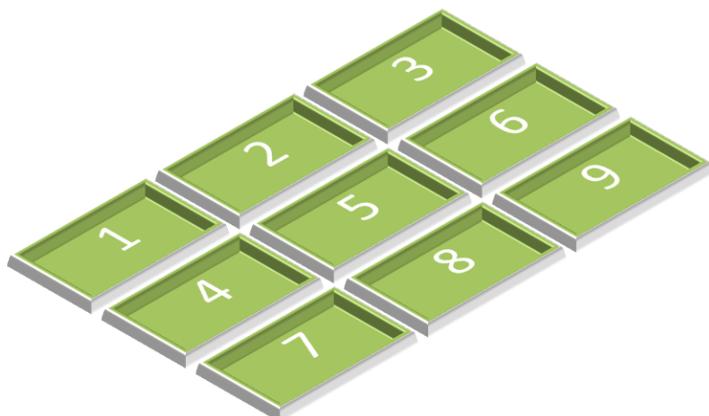
Figura 52 - Sistema de arrumação das caixas das ferramentas segundo a posição no carrossel [Imagem do Autor]
