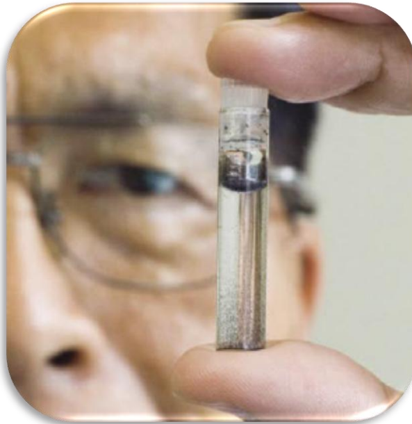
Figura 31 - Tags RFID de dimensões 0.05x0.05mm [Thomas, 2008]
