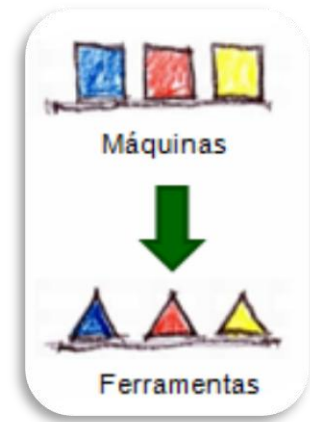
Figura 27 - Ferramentas da mesma cor das máquinas [Imagem do Autor]
