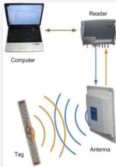
Figura 29 - Funcionamento de um sistema RFID [Google]
