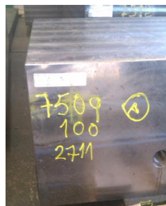
Figura 10 – Identificação dos blocos de material à chegada na fábrica
