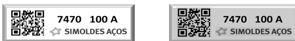
Figura 35 - Placa com etiqueta e placa com marcação via laser ou micro punção
