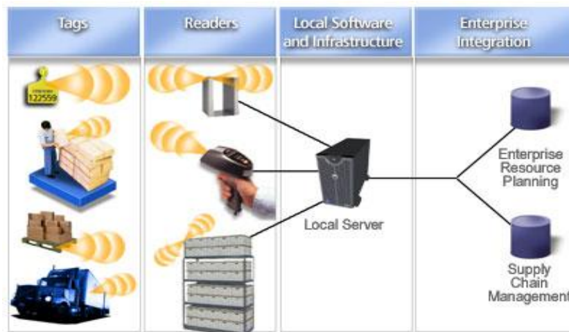
Figura 29 - Sistema de funcionamento da tecnologia RFID(Telecube)
