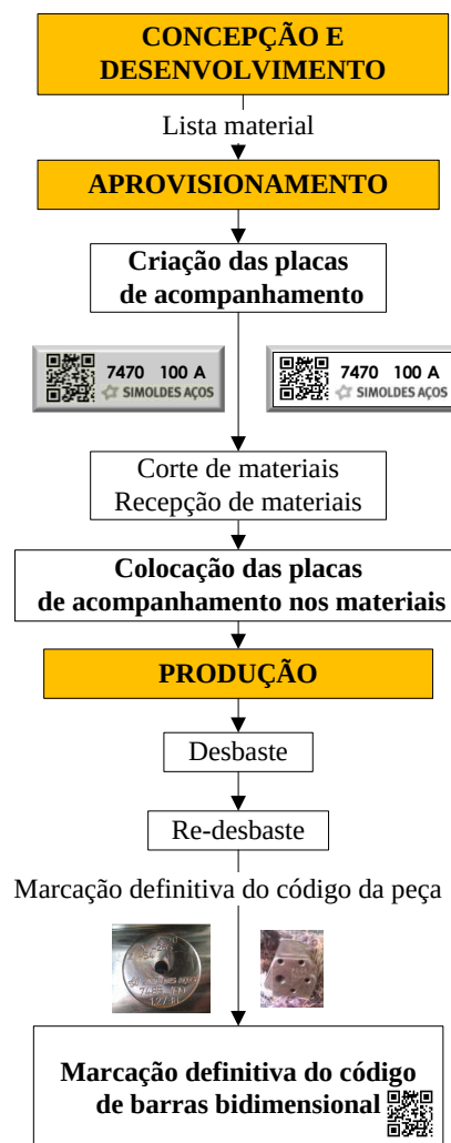
Figura 43 – Fluxograma da metodologia para o sistema de identificação
