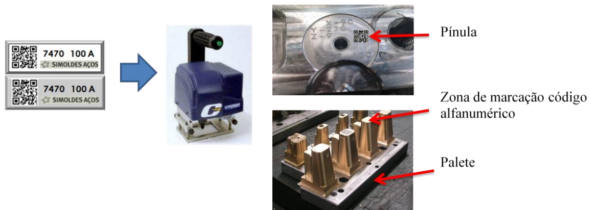
Figura 37 - Esquema do projecto de marcação definitiva de códigos de barra bidimensionais
