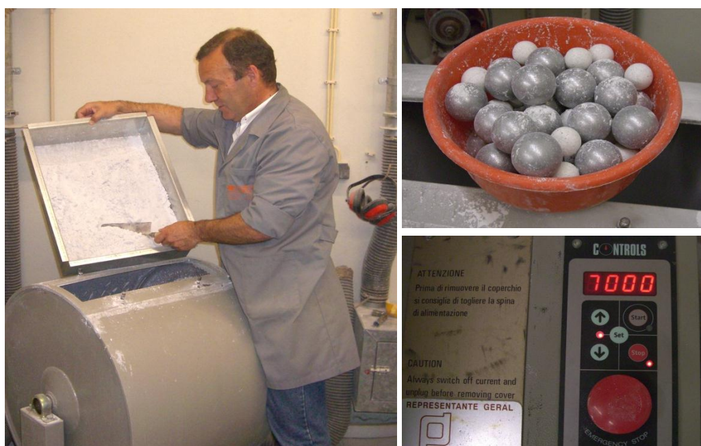
Fig. 3.11 - Preparação do GPF na máquina Los Angeles
