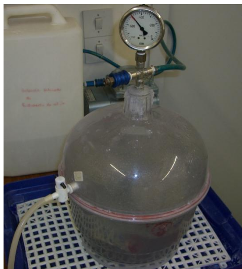
Fig. 6.17 - Preparação dos provetes por saturação de \text{Ca(OH)}_2
