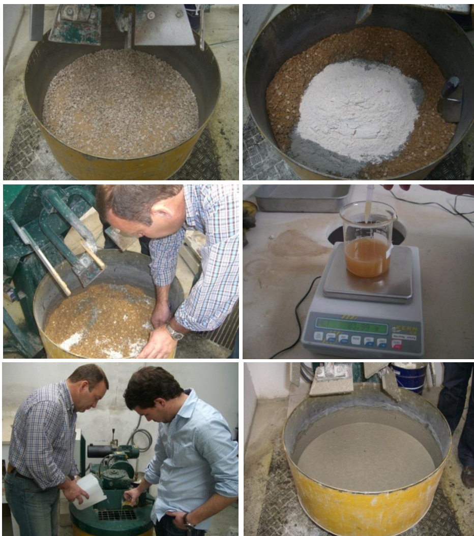
Fig. 4.5 - Sequência da amassadura do betão
