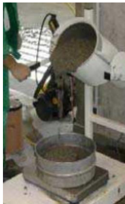
Fig. 5.3 - Ensaio da resistência à segregação no peneiro
