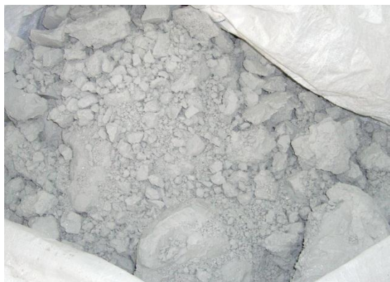
Fig. 3.9 - Aspecto do GPF após ser preparado em moinho com água
