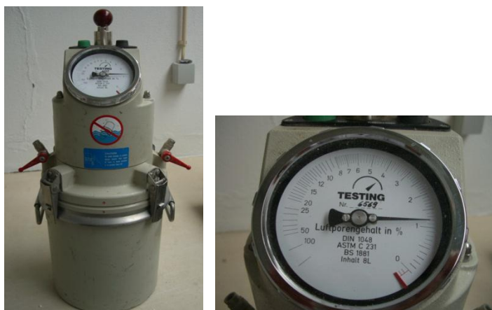
Fig. 3.21 - Aparelho para medir teor de ar (pressiométrico)
