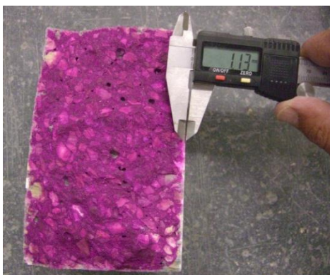
Fig. 6.16 - Medição da penetração da carbonatação
