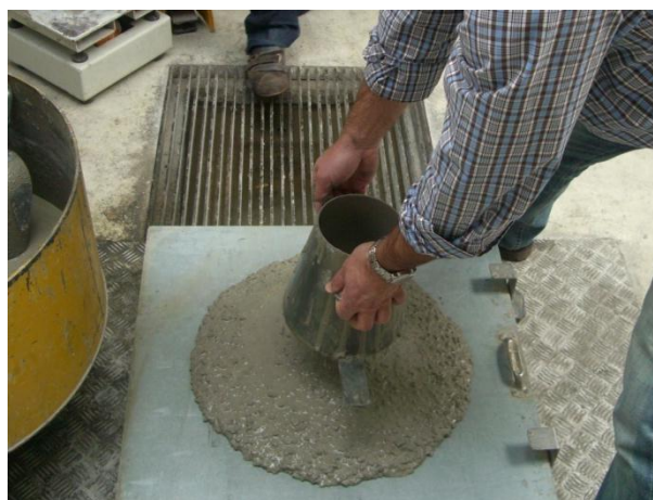
Fig. 4.1 - Ensaio de espalhamento NP EN 12350-5
