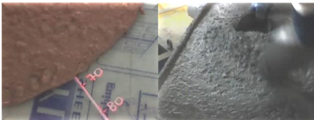
Fig. 5.7 - Ensaio de espalhamento e de penetração por método da sonda
