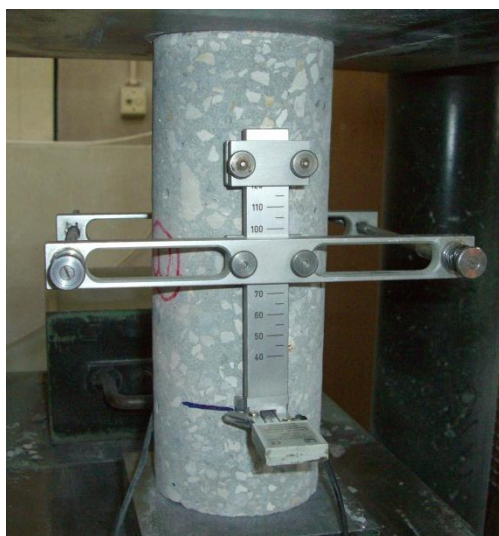
Fig. 6.13 - Ensaio para determinação do módulo de elasticidade por compressão
