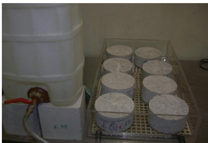
Fig. 6.14 - Ensaio de absorção de água por capilaridade
