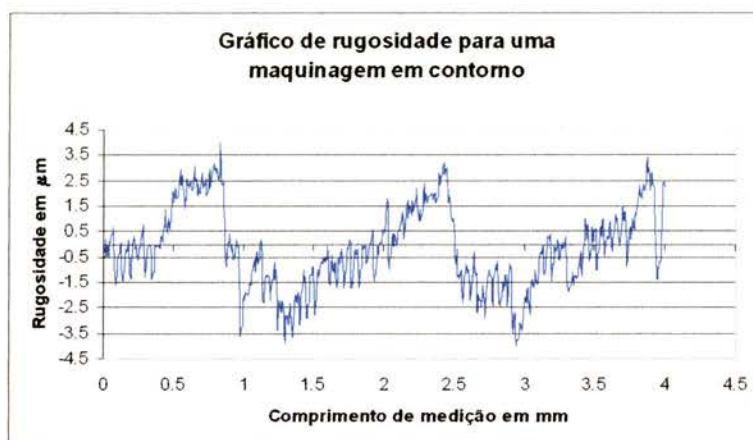
Fig. 108 – Aspecto do perfil de rugosidade numa maquinagem em contorno zig-zag
