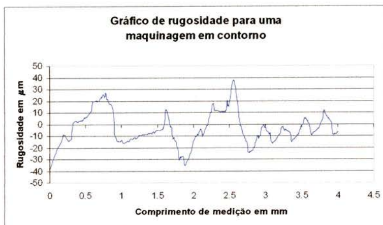
Fig. 100 – Aspecto do perfil de rugosidade numa maquinagem em contorno zig-zag
