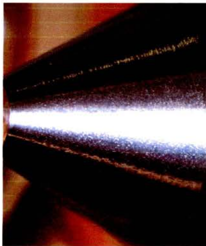
Fig. 119 – Fotografia da textura superficial da superfície cônica após maquinagem em contorno na peça B_O (2.5x)
