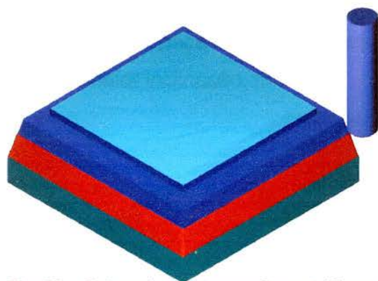
Fig. 52 – Pré-acabamento com fresa \phi 16mm em contorno
