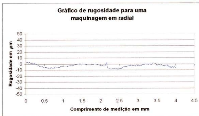
Fig. 101 – Aspecto do perfil de rugosidade numa maquinagem em radial
