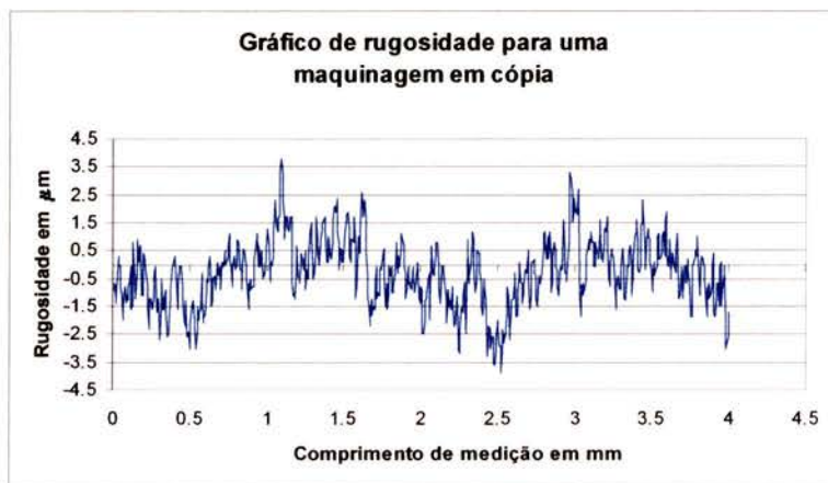
Fig. 107 – Aspecto do perfil de rugosidade numa maquinação em cópia 45° zig-zag
