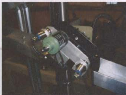
Figura 17 - Colocação dos sensores fotoelétricos e do electroímã
