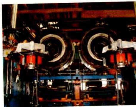
Figura 15 - Limpeza de moldes sem desmontagem do equipamento
