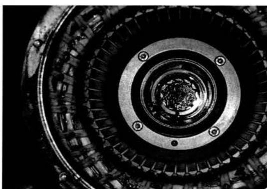
Figura 4.7 - Representação dos enrolamentos estáticos e do rolamento do lado não transmissível de movimento do motor de tracção
