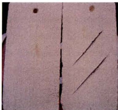
Figura 1: Aspecto apresentado pelos provetes sujeitos ao ensaio de envelhecimento no Klimatron .
