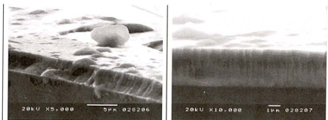
Figura 19. Crescimento colunar do revestimento na amostra de controle
