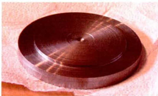
Figura 5. Uma matriz acabada de sair do torno [1]
