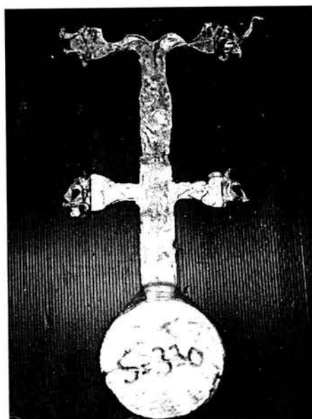
Fig. 14.2 – Resultado do ensaio para determinação da posição do pistão quando o metal chega à secção de ataque das peças.
