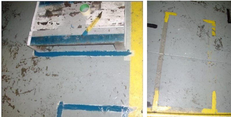
Figura 26 – Marcação do posto de trabalho diferenciando as ferramentas fixas dos
