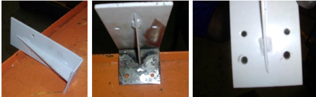
Figura 19 - Aumento do diâmetro dos furos devido ao erro de medição
