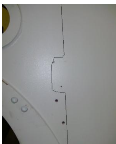
Figura 17 – Marcação, Correção de furos e redução de tamanho nas guardas laterais e posteriores
