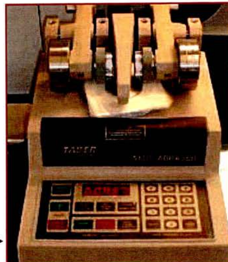
Figura 20. Abrasímetro de Taber. →
