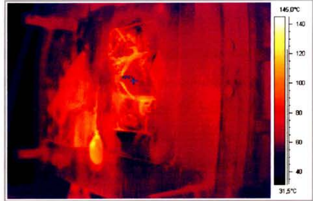
Figura 24 – Termogramas do molde, lado fixo, com termo regulação.
