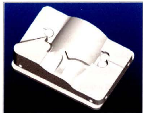
Figura 16 – Inserção lado fixo (modelo CAD).
