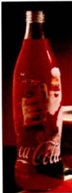
Esta técnica envolve as embalagens com uma manga de plástico retráctil, que se adapta, após a passagem por um forno de retracção, à forma da embalagem.
