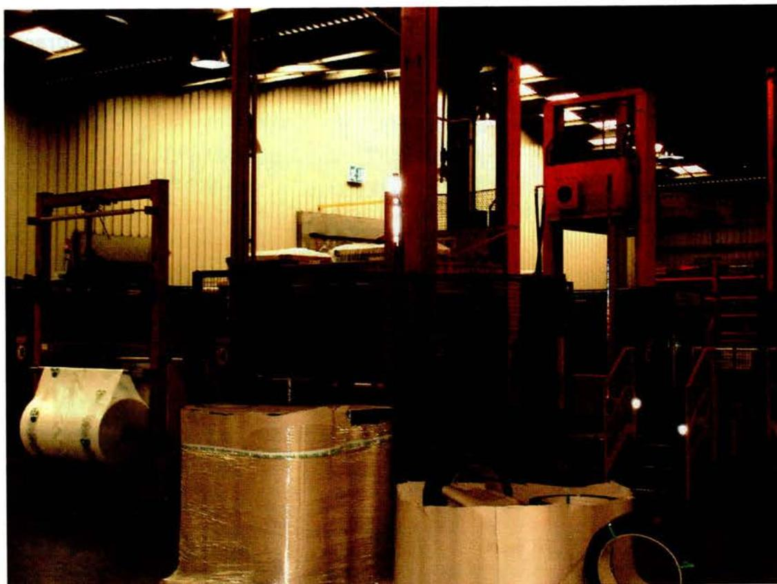
Figura B3.3 – Forno de retracção
