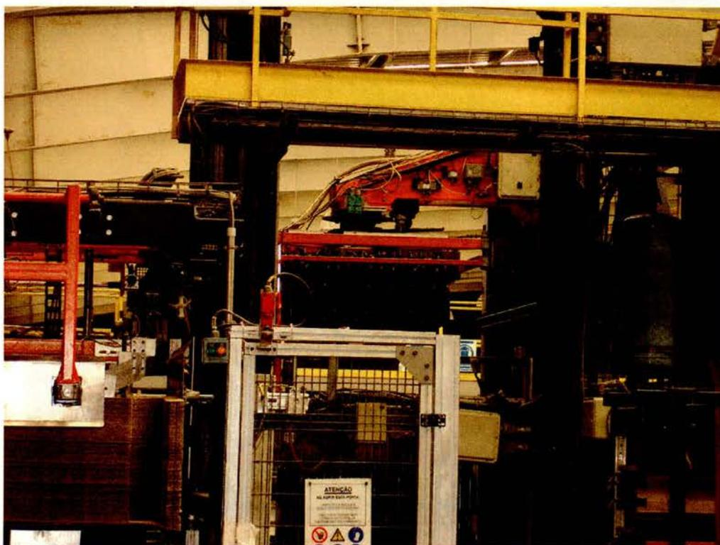
**Figura B3.2 – Paletizador automático do AV5**
