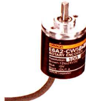
Figura 20 – Imagem dos encoders usados (ref. E6A2–CW5C)
