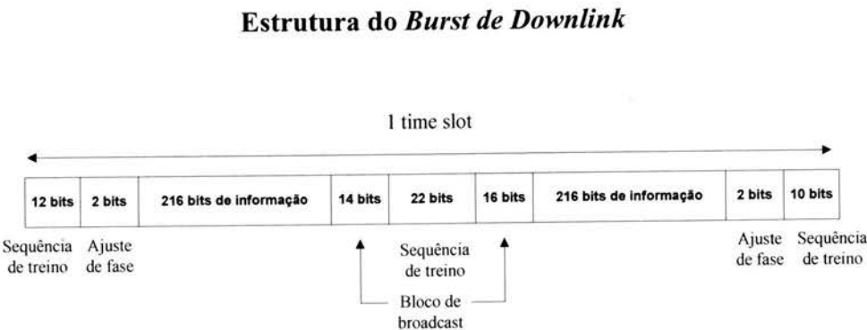
Figura 4.6 – Estrutura do burst de downlink do TETRA V+D
