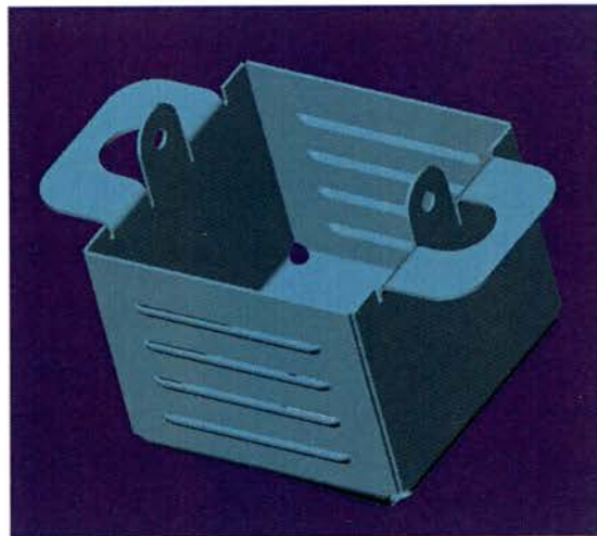
Figura 23 – Peça obtida através dos comandos do menu “Sheet Metal”
