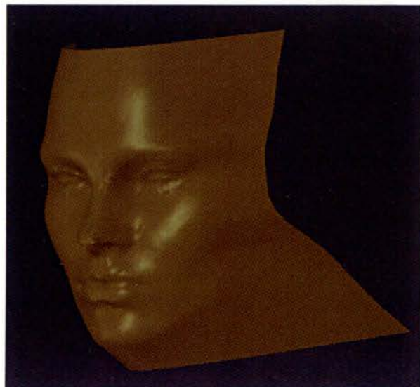
Figura 18 – Definição de uma superfície através de uma nuvem de pontos
