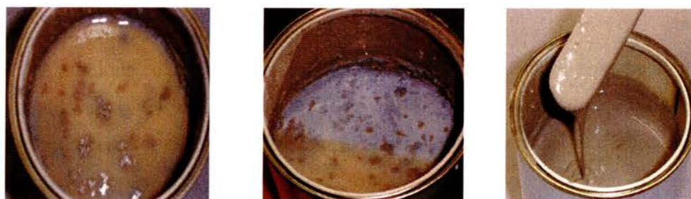
Figura 9 – Aspecto da tinta 15_v3 após teste de estabilidade acelerada.
