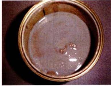
Figura 7 – Aspecto da tinta 15_v2 após teste de estabilidade acelerada.
