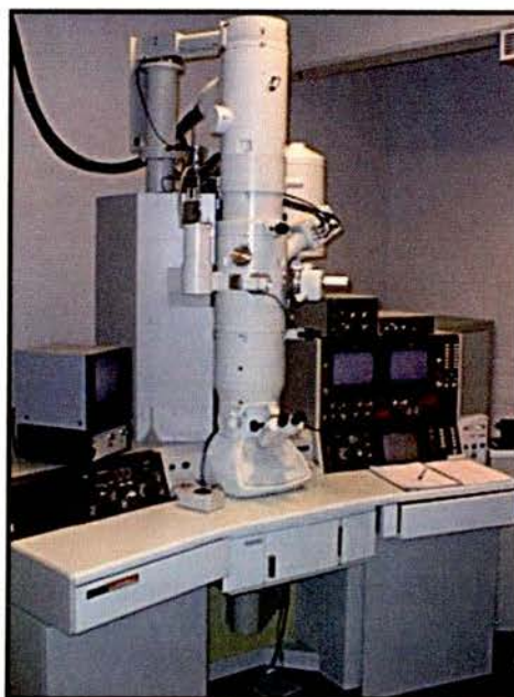
Figura 5: Microscópio electrónico de transmissão e esquema da posição das lentes. [10]
