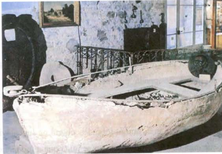
Figura 2.1: Primeira construção de betão armado. Barco de Lambot (1840)
