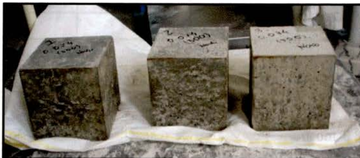
Figura 8.4: Provetes de betão 300 – R kg/m 3 , calibre de corte 0.074
